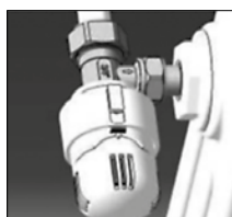
4. Выберите в соответствии со шкалой (см. упаковку) требуемое положение термоголовки и при необходимости зафиксируйте ползунком. Фиксация происходит при расположении ползунка строго напротив цифры. Установка требуемой комнатной температуры производится вращением термостатической головки, имеющей градуированную шкалу для облегчения установки.
