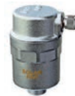
Рис. 1. При отсутствии воздуха в системе вода поднимает поплавок до полного закрытия затвора.
